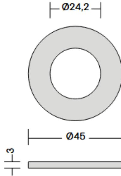
Falls das Bohrloch zu groß ist oder ausgefranzt, empfehlen wir den Einsatz einer Rosette. Dies unterstützt auch die Stabilität.
